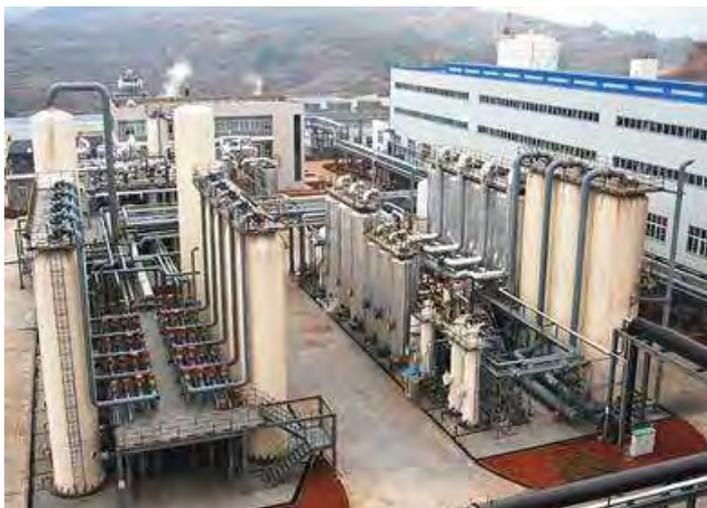
Ilustración 3. Planta de producción de hidrógeno por reformado con vapor.
