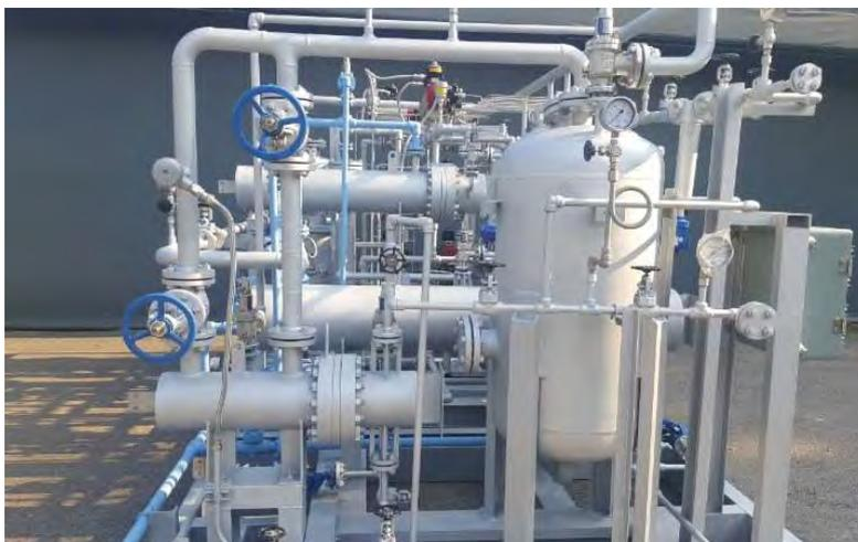
*Sistema DE-OXO y secado de hidrógeno.*
